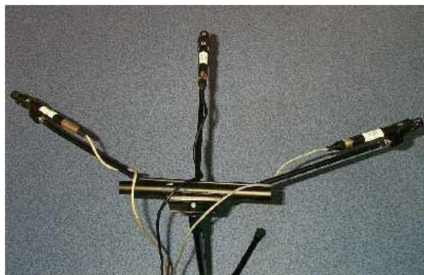
Figure 2. Procédé triphonique utilisé : 3microphones cardioïdes, angle 60^\circ , distance 53cm
